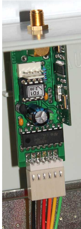
Bsp.: Einbau in Gehäuse über Montagbohrung D6,5mm
