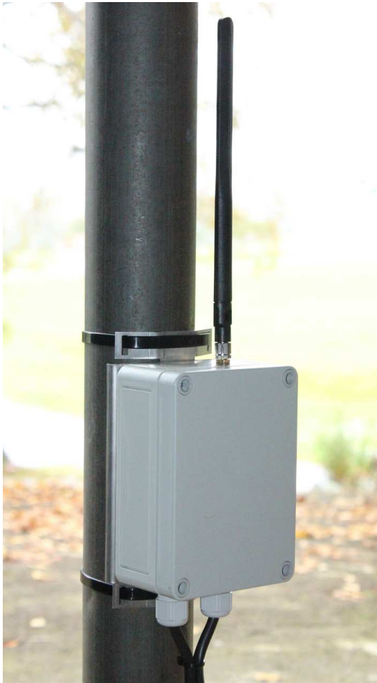
Gehäuse -G130 fertig an Mast montiert
